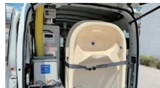
お湯を沸かすためのボイラーや分割式浴槽を積んでいます
